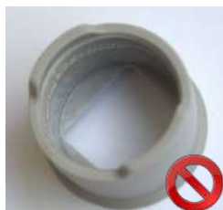
EMBOUT ENDOMMAGÉ Aspect interne et/ou extérieur brillant et collant
